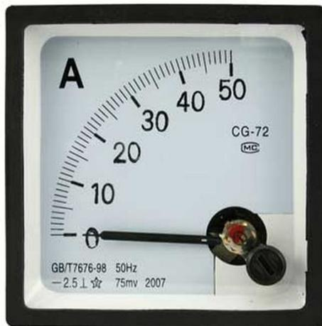
**Амперметр** - это прибор для измерения силы тока.
